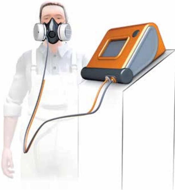
(Essai d'ajustement quantitatif
